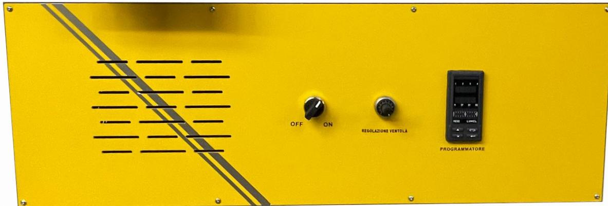
Il controllo della temperatura e del ciclo di cottura è affidato ad un programmatore a microprocessore Lumel RE82. Si possono configurare e memorizzare un massimo di 15 programmi, cadauno composto da un massimo di 15 rampe.
