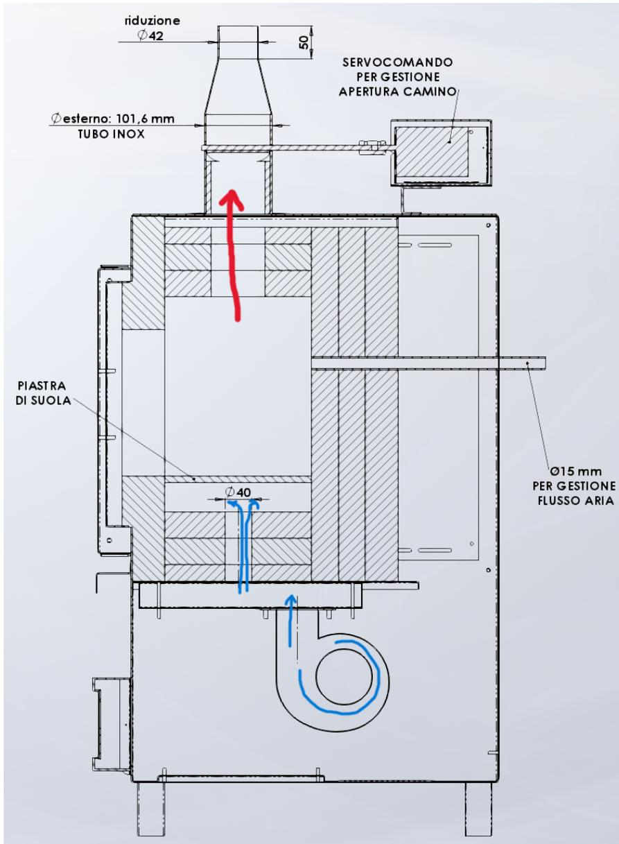
Quando si configura il programma per eseguire il ciclo di cottura occorre prestare attenzione alla programmazione del camino superiore e della ventola inferiore.
