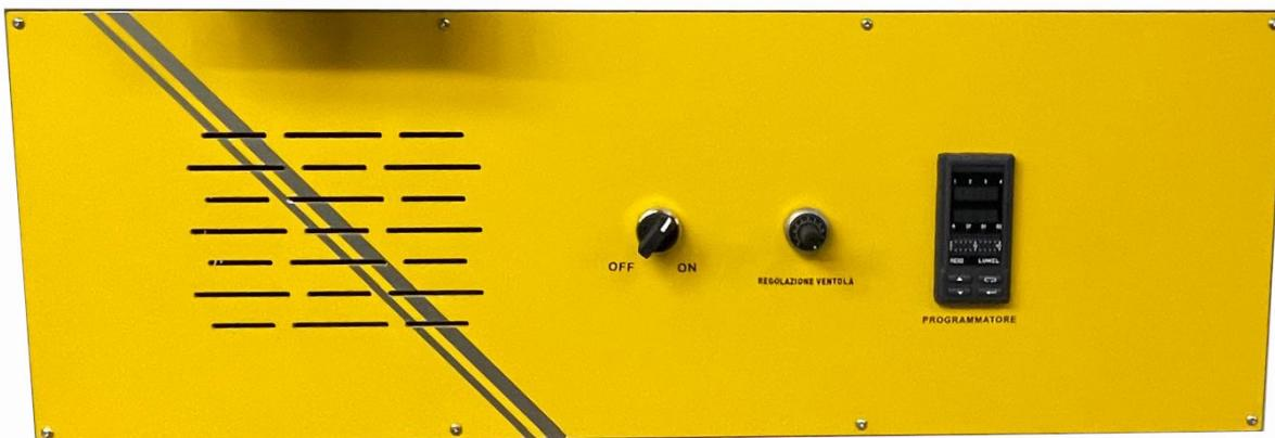
Il controllo della temperatura e del ciclo di cottura è affidato ad un programmatore a microprocessore Lumel RE82. Si possono configurare e memorizzare un massimo di 15 programmi, cadauno composto da un massimo di 15 rampe.
