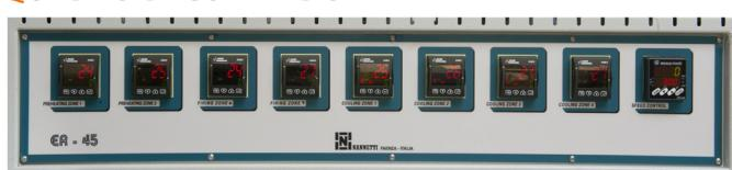
Ogni zona in cui sono presenti le resistenze (preriscaldo, cottura e raffreddamento), è gestita da un piometro auto-regolatore potenziometrico il quale opera comandando delle unità statiche.
