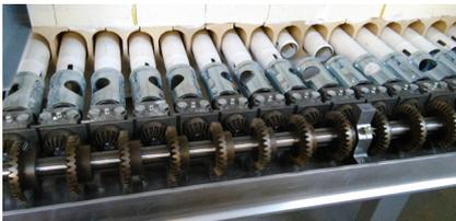
Il secondo pignone è assemblato su un asse, supportato da 2 cuscinetti, mentre all'altra estremità dell'albero è fissata una boccola che, tramite due molle assiali, trasmette la rotazione ai rulli ceramici.
