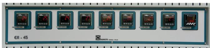
Ogni zona in cui sono presenti le resistenze (preriscaldamento, cottura e raffreddamento), è gestita da un pirometro auto-regolatore potenziometrico il quale opera comandando delle unità statiche.
